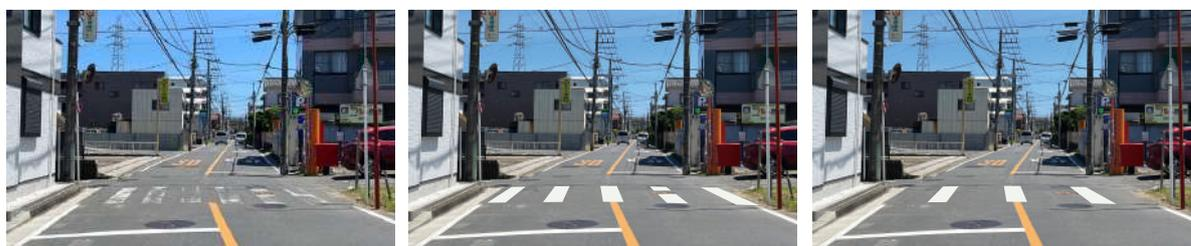
図5 提示した写真（左から白線設置間隔 45cm、90cm、135cm）
