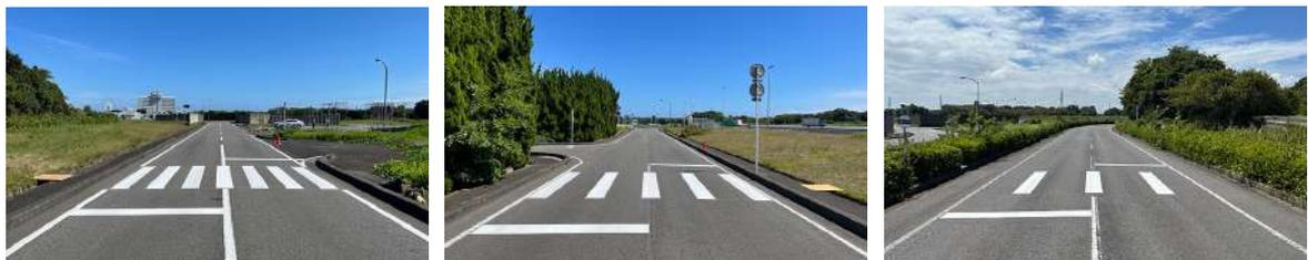
図 1 実験で設置した横断歩道（左から白線設置間隔 45cm、90cm、135cm）
